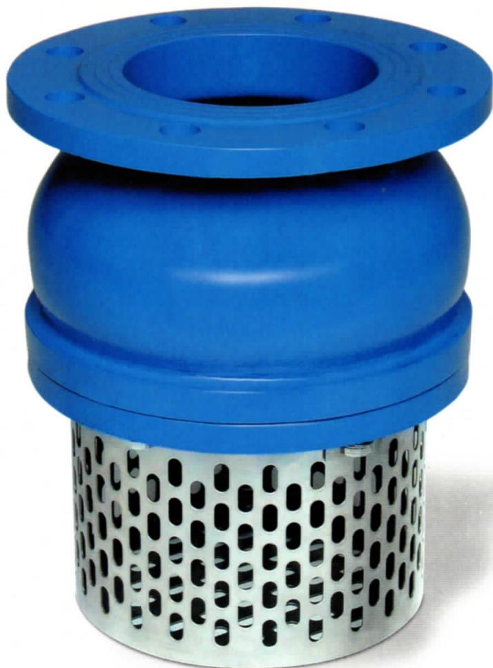
La Válvula de Pie se instala en la base de aspiración de las bombas para evitar el descebado de las mismas. El colador, de acero inoxidable, protege los equipos de cuerpos extraños que puedan dañar los elementos de las bombas.
